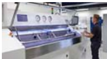
Bancs tests pour huile hydraulique et eau, jusqu'à 300 L/mn
