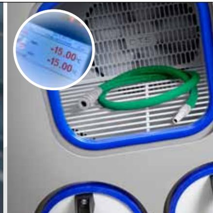
**Zona de prueba CEJN: los kits de mangueras pasan estrictos controles así como explosiones o temperaturas extremas.**
