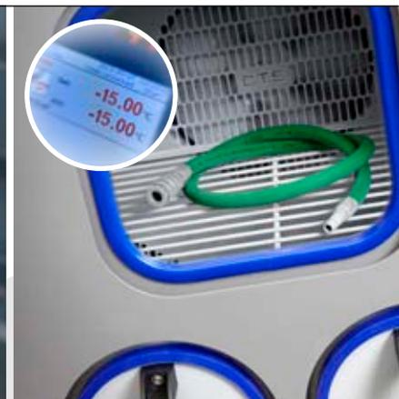
**CEJN Testlabor: Die Schlauchsets werden hier strengen Tests unterzogen, z.B. Beanspruchung durch extreme Temperaturen.**
