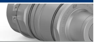
정격 유량.. .40-291 l/min @ 3bar ΔP (10.6-76.9 GPM @ 43.5 ΔPSI) 사용 온도 .-30°C - +100°C (-22°F - +212°F) 카플링 재질 스틸 .스틸 니쁠 재질 씰 재질. . NBR 최대사용압력, 연결시 . 42.0 MPa (6091 PSI) 최대사용압력, 분리시 . 40.0 MPa (5801 PSI) 최대 파열 압력, 연결시: . 168.0 MPa (24366 PSI) 최대 파열 압력, 분리시. . 100.0 MPa (14503 PSI) 시스템 내부의 압력 상승에 따라 더욱 우수한 체결을 가집니다. 자세 한 기술정보는 세인(CEJN) 한국 법인 또는 가까운 대리점에 문의하시 기 바랍니다. 카플러 연결 방법.. 압력이 있을때 분리... . Yes
